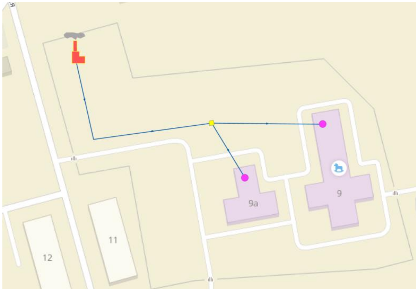
Рис. 14. Тепловые сети от котельной по адресу: ул. Центральная, 9
